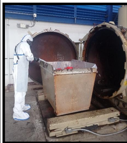
Fotos 9 y 10. Ejemplo de tratamiento por calor húmedo (autoclaves) utilizado en el Hospital Santo Tomás.
