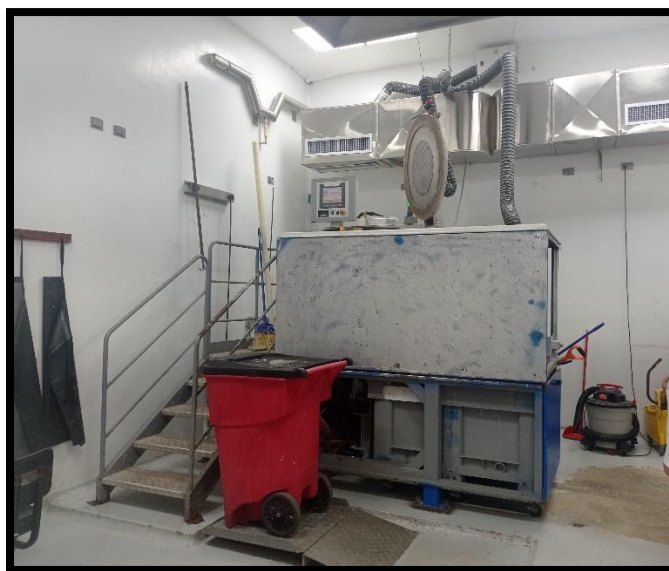
Foto 11. Ejemplo de tratamiento por microondas utilizado en el Hospital Dr. José Renán Esquivel (Hospital del Niño)
